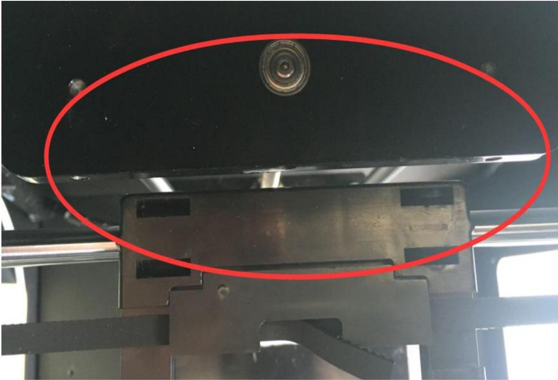
二、当你看到不平行的时候，你可以双手抓住X轴模组的两个塑料件，稍微扳动一下放X轴模组与Z轴铝件平行
