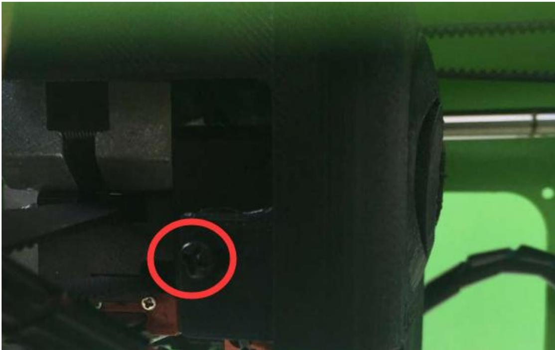
2. 把固定挤出机模块的螺丝松，让挤出机模块能够顺畅的上下移动，但不要把螺丝拧下来。
